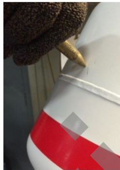
Colocación de un punzón antichispas para perforar
